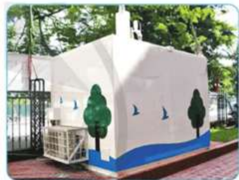
Hình 4.4. Trạm quan trắc môi trường không khí tự động
